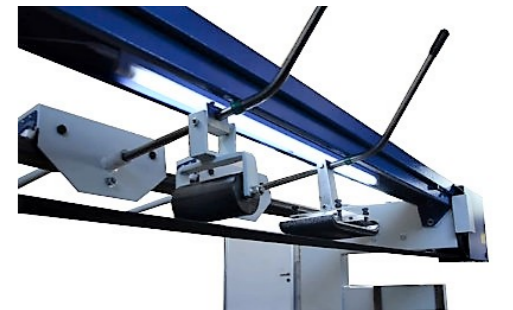
PUNTO LUCE SUL PIANO Il punto luce sul piano di lavoro garantisce una qualità migliore del lavoro e agevola l'operatore.
