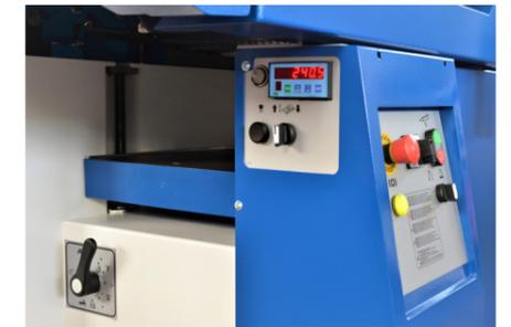
**QUATTRO VELOCITÀ DI AVANZAMENTO SPESSORE**
