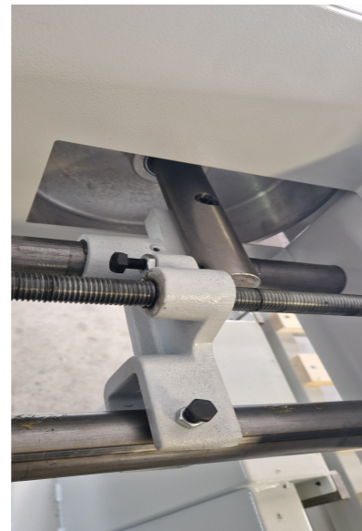
TENDINASTRO IN GHISA Il nostro tendinastro di grandi dimensioni in ghisa, garantisce un'ottima tensione per tutte le tipologie di nastri.
