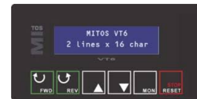
INVERTER Possiamo equipaggiare la macchina con un inverter, per venire incontro a qualsiasi finitura che il cliente desideri eseguire, questo tipo di inverter mantiene anche a basse velocità un'ottima coppia motrice. Il terminale di comando è intuitivo e permette di lavorare in senso orario e antiorario.
